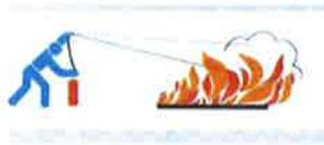
Feuerlöscher nie probeweise betätigen! Löschmittelstrahl stets von unten beginnend die Löschmittelwolke über das Brandobjekt legen.
